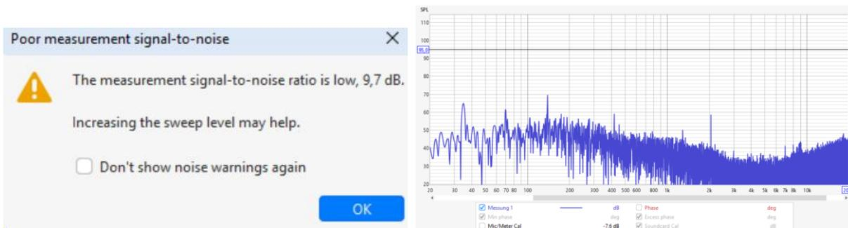
Bei dieser Gelegenheit die Info, mittels „Limits“ oben rechts das Bild mittig zu justieren. Mit „Fit to data“ werden die Messungen vollständig und mittig angezeigt, während bei „Apply settings die angegebenen Min- und Max-Werte die Skalen bilden.
