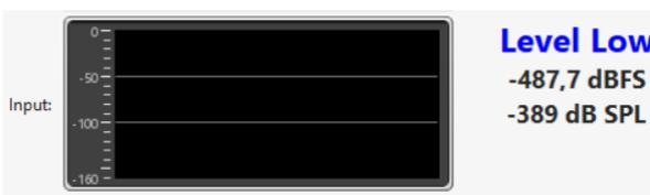
Das Programm prüft leider nicht wirklich den Unterschied zwischen Signal vom Lautsprecher und Signal aus der Messumgebung ab. Hier das Resultat bei abgeschaltetem Lautsprecher, aber mit hohem Grundpegel vom Mikrophon:
