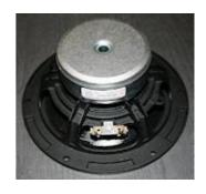
AL170 mitbringt und auch rein optisch besser zum Subwoofer passt: **18W8434G00**. Dieser wird dann im geschlossenen Gehäuse von ca. 13 Liter betrieben, wobei er sich bei ungefähr 80 Hertz nach unten hin verabschiedet. Nach oben schließt er an die Mitteltonkalotte bei ca. 700 Hertz an.
